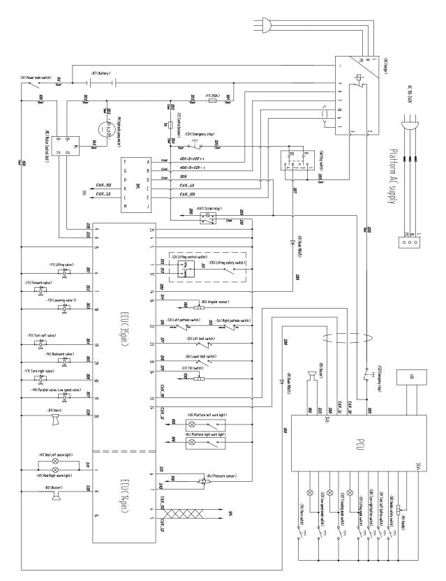
Figure 3-12 ZS2646HD-Li/ZS2632HD-Li/ZS2032HD-Li Electrical schematic
